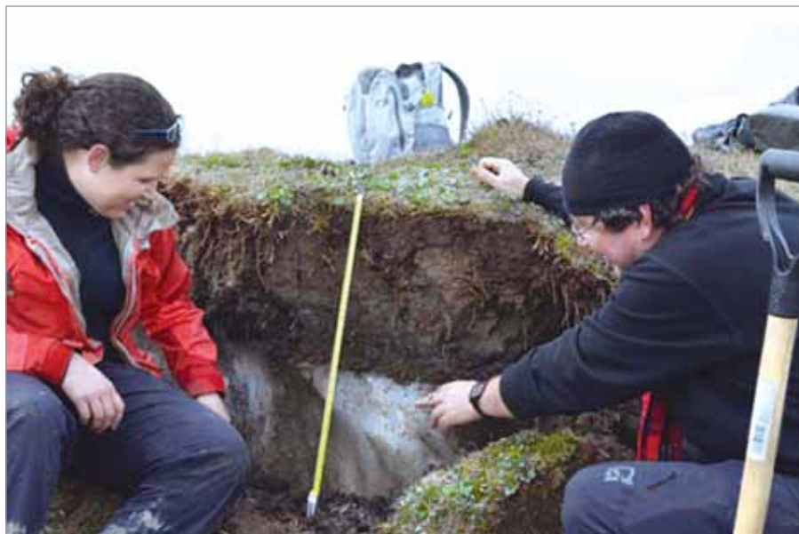
Рис. 2.10 Анализ вертикального разреза многолетнемерзлых пород с ледяными жилами
