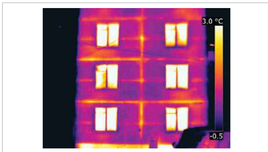
Рис. 5.2 Пятиэтажный дом серии ГИ постройки 1960-х годов «светится» от теплопотерь меж- панельных стыков. Решением (если речь не идет о сносе или капитальном ремонте) может быть только качественный ремонт фасада с применением современных материа- лов
